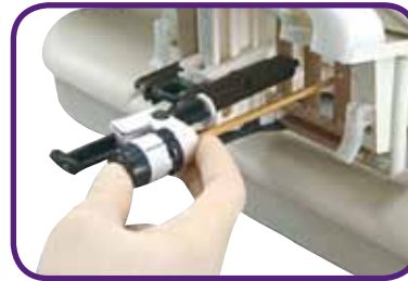
Z-Schraube/Z-Tiefenstop ermöglicht Ihnen, feine Anpassungen vorzunehmen (kleiner als 2mm) und Ihre Position (Tiefe) auf der Schiene fest einzustellen.
